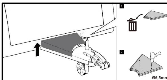
Entfernen Sie die Abdeckhaube der Deichsel (1) oder bohren Sie Löcher in die Abdeckhaube für die Befestigungsschrauben (2).
