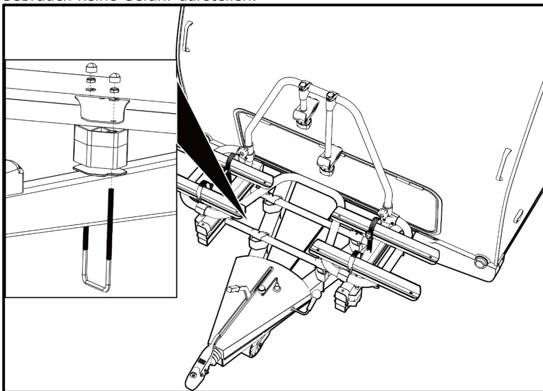
Um dafür zu sorgen, dass der Träger auf seinem Platz bleibt wird dieser fixiert, indem Sie die vier Bohrungen der Gegenbleche in das Basisrohr übertragen. Bohren Sie diese Löcher 4 mm groß. Danach wird mit den mitgelieferten Schrauben der Träger fixiert.
