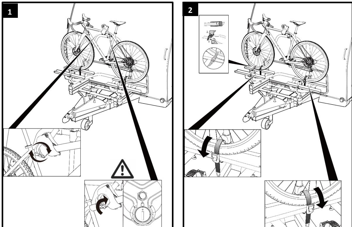
Um ein Verdrehen zu verhindern, sichern Sie das Vorderrad des Fahrrades immer doppelt mit dem mitgelieferten kurzen Textilband.
