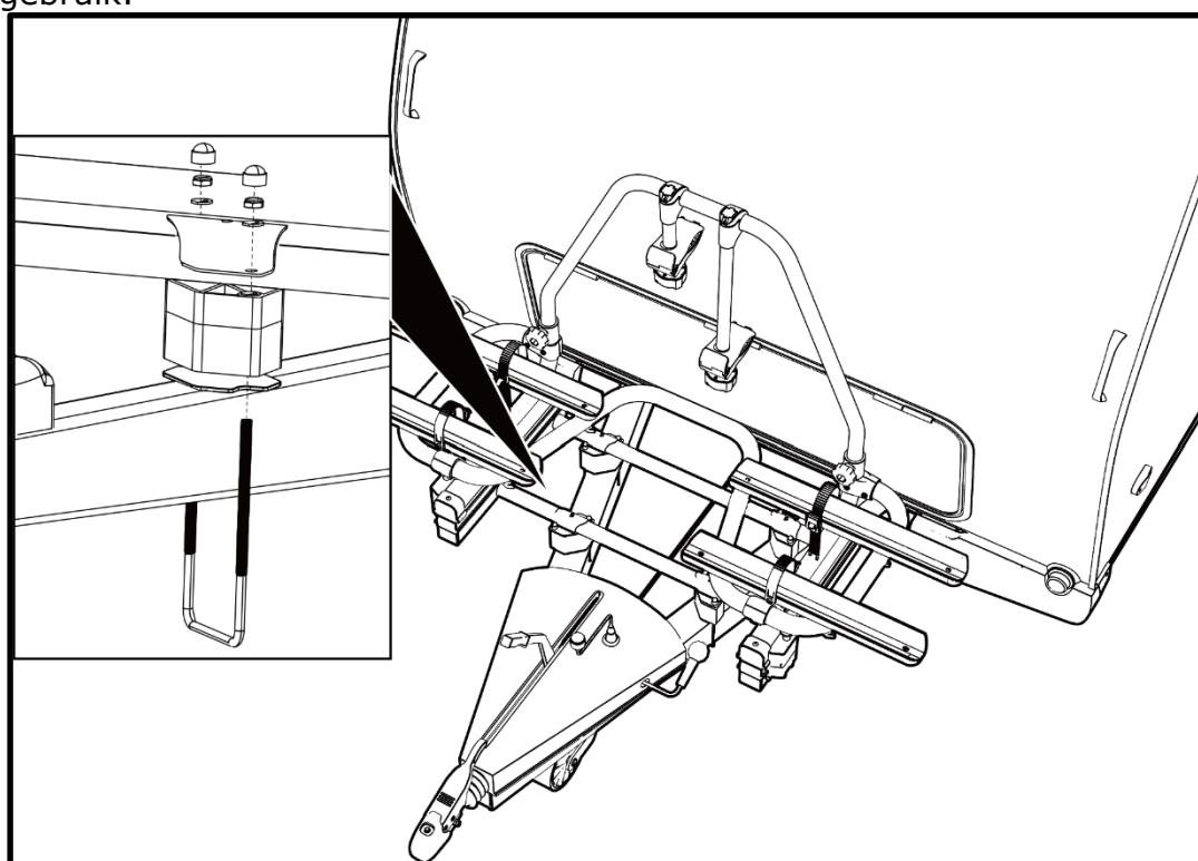
Om er voor te zorgen dat de drager op zijn plaats blijft dient deze geborgd te worden met de vier schroefjes. Hiervoor moeten eerst vier gaatjes (4 mm) geboord worden in het basisdeel en daarna kunnen de beugel en het basisdeel vastgeschroefd worden.
